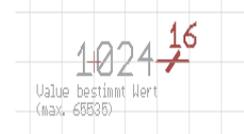
Beispiel: Über Wert\_16 wurde ein 16Bit Signal mit einem Dezimalwert von 1024 erzeugt. Der Wert wird als Hexzahl über die RS232 Schnittstelle ausgegeben.
