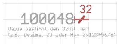
Beispiel: Über Wert\_32 wurde ein 32Bit Signal mit einem Dezimalwert von 100048 erzeugt. Der Wert wird über den Baustein V24Ausgabe als Hexzahl ausgegeben.
