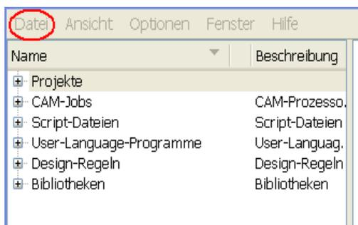
Über „Datei“ „Öffnen“ „Schaltpläne“ eine leere Vorlage auswählen. Die Schaltpläne befinden
