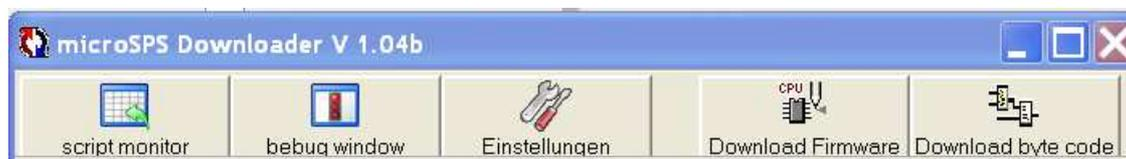
Über die Schaltfläche „Einstellungen“ können Erweiterungen wie I2C Schnittstelle oder die LCD Anzeige aktiviert werden. Dazu zuerst über „read“ die Einstellung lesen, ändern und mit „write“ Speichern. Die Einstellung ist im EEPROM abgespeichert. Mit einem RESET werden die Einstellungen von der microSPS übernommen.
