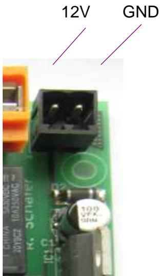
**Versorgungsspannung 12V oder 24V**
